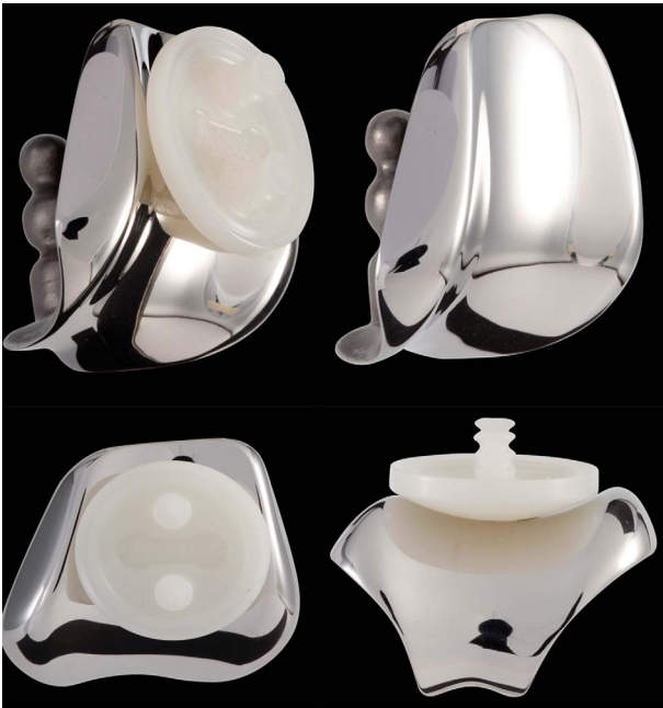
Figure 3. Médaillon rotulien et implant trochléen. La forme des implants trochléens et patellaires permet d'optimiser la course patellaire en maintenant un maximum de contact, et en diminuant ainsi les contraintes. Il existe une interchangeabilité totale entre taille de bouton rotulien et taille de composant trochléen.
