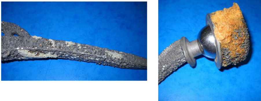
Figure 4. La surface irrégulière et réhabitable du pomométal : plages de réhabitation sur des explants, fémoral et cotyloïdien.
