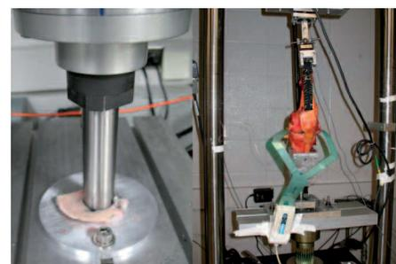
Figure 11 : Tests biomécaniques: Push-out Test à gauche (reflète l'ostéo-intégration de l'implant testé). Analyse des pressions transmises aux plateaux tibiaux grâce à l'utilisation d'un Tekscan, à droite.
