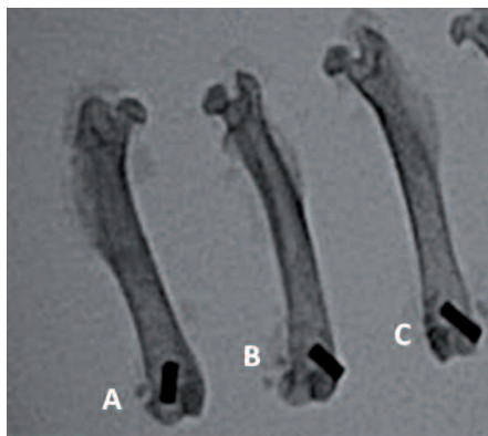
Figure 3 : Radiographie comparative de fémurs de rats avec 3 types de cylindres : titane recouvert d'hydroxyapatite et nanotubes de carbone (A), titane recouvert d'hydroxyapatite (B) et titane nu (C)
