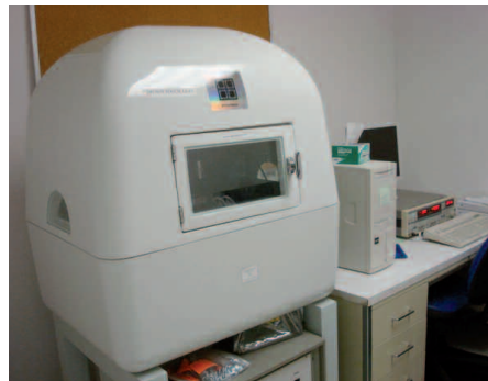
Figure 5 : Nanoindenter de chez Hysitron® pour la technique de nanoindentation
