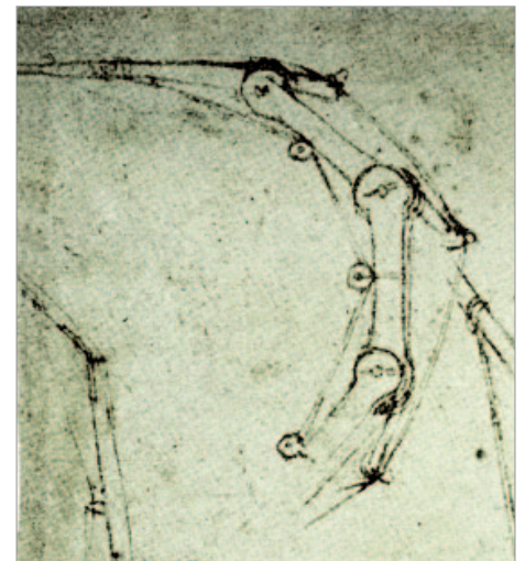
c. Détail de la planche « Machine volante en action », CA fol 747r / 276 – rb, 1486 – 1490. Ce détail de machine volante rappelle étrangement avec ses poulies, articulations et câbles l'anatomie du doigt.
