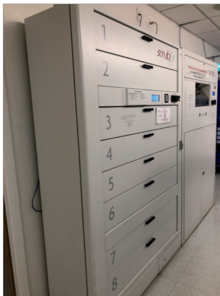
Figure 4. Exemple de machine « ScrubX », qui permet de délivrer sa tenue de bloc après vérification du numéro d'identification et du mot de passe.
