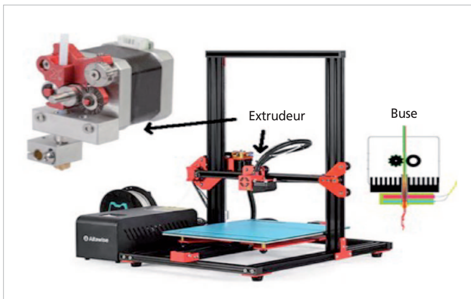
Figure 9. Compléments matériels lors de la phase de fabrication avec l'extrudeur et la buse qui chauffent le fil plastique pour construire la maquette selon la méthode FDM (Fablab : LabSud, Montpellier).
