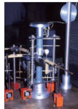
Figure 45. Méthode de mesure (essai en flexion frontale) pour l'évaluation de la stabilité des fixateurs externes (laboratoire de biomécanique de l'ENSAM).
