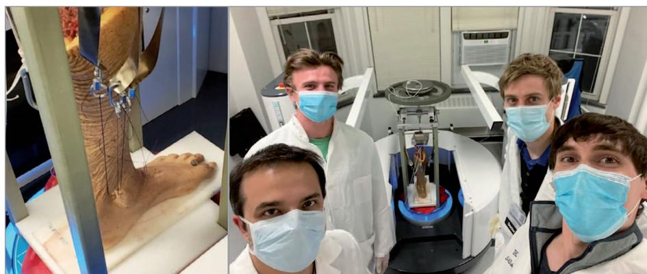
Modèle cadavérique simulant une mise en charge : reproduction des tensions tendineuses (à gauche), charge axiale et analyse dans le scanner en charge avec l'équipe de recherche (à droite).
