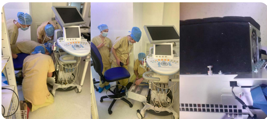
Figure 5 - Notre équipe au bloc, en cours d'intervention de réparation de la machine d'élastographie à la suite d'une panne. Nous avons démonté l'unité centrale afin de faire vérifier la carte graphique par le service informatique (la recherche requiert une pluripotence technique).
