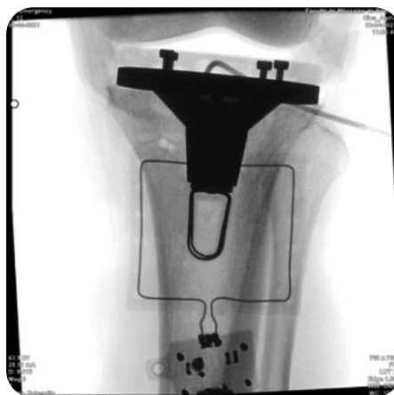
Figure 2 - Radiographie d'une prothèse totale du genou connectée.
